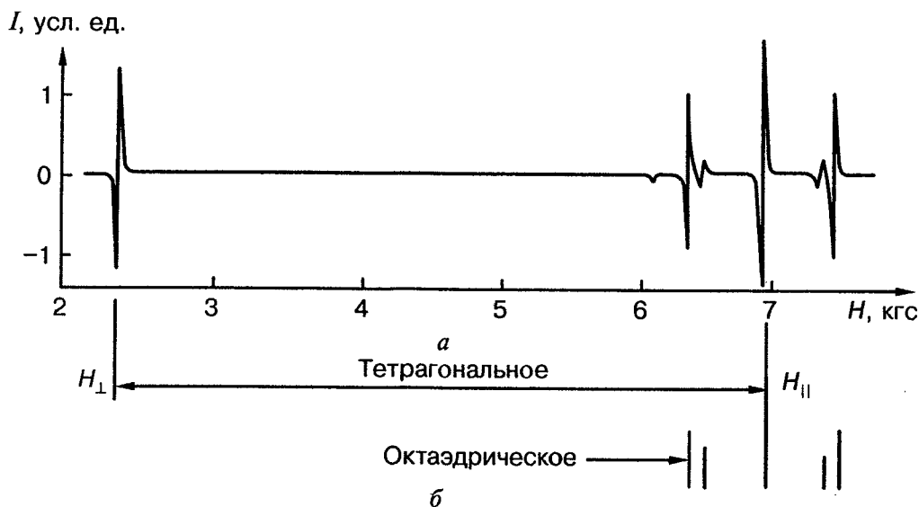
Рис. 3.87. Спектр ЭПР иона \text{Fe}^{3+} в \text{SrTiO}_3 для H_{\parallel} (ионы \text{Fe}^{3+} локализованы в местах тетрагональной и октаэдрической симметрии): T = 300 \text{ K} , \nu = 19,445 \text{ ГГц} ; внизу приведены штрих-диаграммы спектров ионов в тетрагональном (а) и октаэдрическом (б) окружениях
